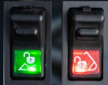
Interruptor de seguridad (cargadora) Interruptor de seguridad (retroexcavadora)
